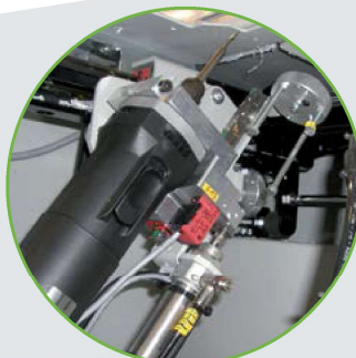
Bohr-/Fräsaggregat von unten mit Winkelverstellung 0-65°
