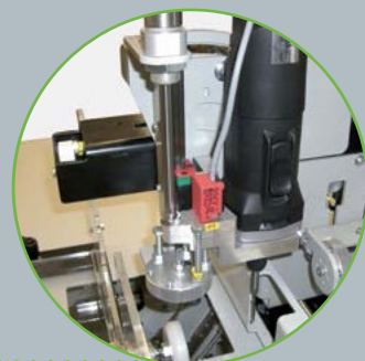
Bohr-/Fräsaggregat oben mit 6-fach Revolveranschlag
