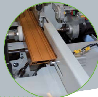
Pneumatische Profilanschläge (links und rechts)
